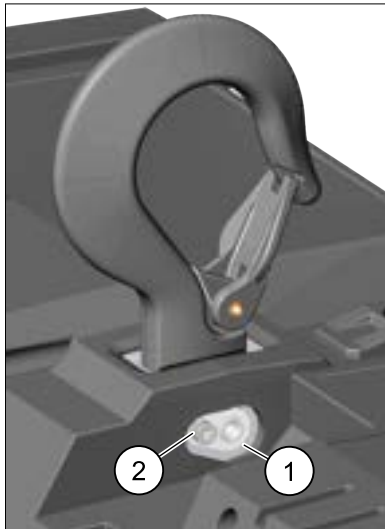
Figure 7. Retenue de la goupille de suspension/vis de retenue
