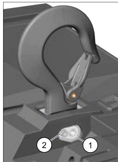
Figura 7. Pasador de suspensión/tornillo de retención
