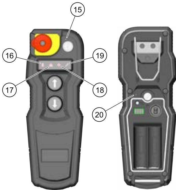
Figura 5. Indicadores LED y alertas del control remoto
