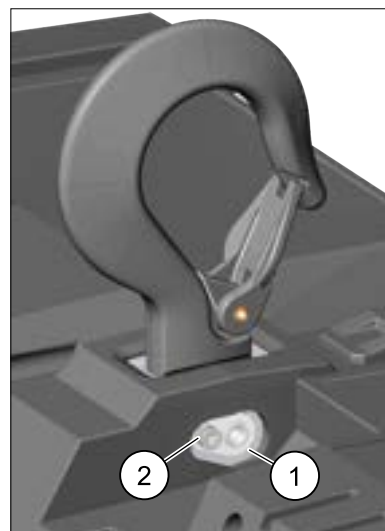
Figura 7. Retentor do pino de suspensão/parafuso retentor
